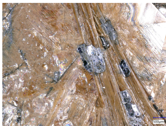
FIGURE 5 – Cristaux visibles à l'œil nu sur le creuset [YIGG] (grossissement x50)
